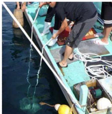
ロープを使って海底に設置
