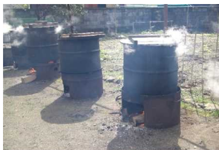
図2 鉄釜で煮熟する様子
