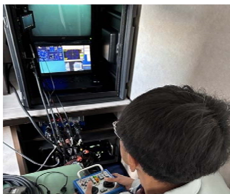
図 3 船上での ROV 操縦
