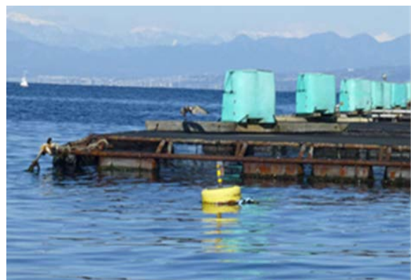
写真 1 内浦地先に設置した水温観測ブイ(中央の黄色ブイ)
