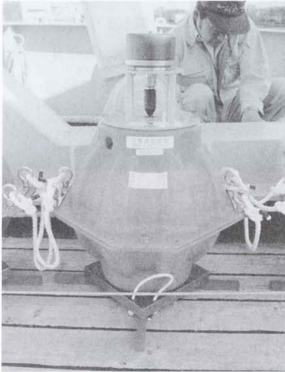
写真1 海底局（海底位置観測装置）
