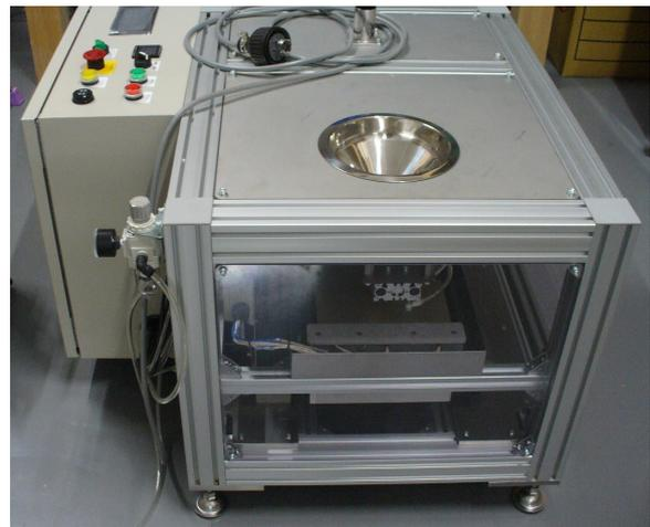
写真 1 開発した発煙装置
