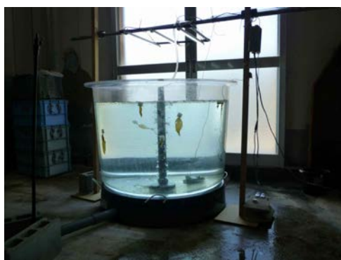
図 1 500L パンライト円形水槽の設置状況
