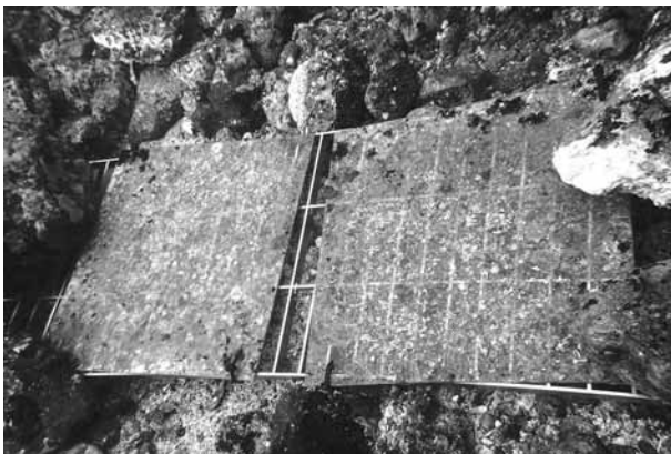
図2 使用したコレクター(海底での設置状況)
