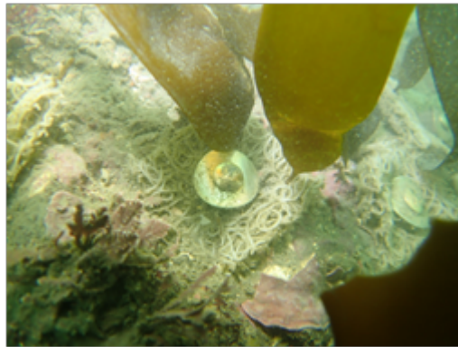
図9 海域に設置した基盤の状態 (3週間経過)
