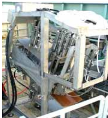
船上に設置されたカツオの脱血装置
