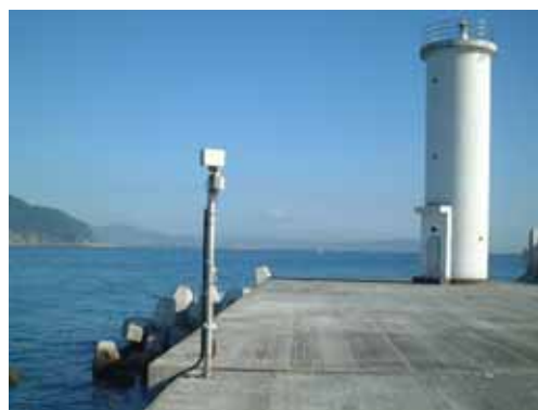
小川港防波堤の水温連続観測装置
