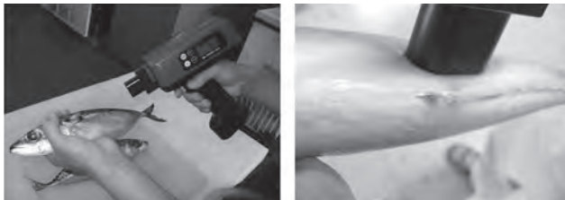
図2 小型近赤外測定機によるゴマサバ脂肪含量の測定
